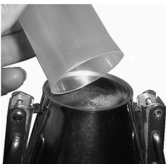
4. Prüfgut vorsichtig in CM-Gerät einfüllen.
