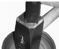
2. Durchschnittsprobe **im Beutel** in der Schale soweit zerkleinern, dass ein völliges Zerkleinern in dem CM-Gerät mit den Kugeln möglich ist.
