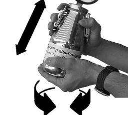
8. Durch kräftiges Hin- und Herbewegen sowie durch kreisende Bewegungen das Prüfgut im CM-Gerät mit Hilfe der Kugeln völlig zerkleinern. Dauer: 2 Minuten
