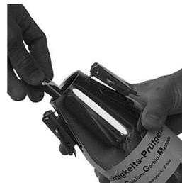
5. CM-Gerät schräg halten und Glasampulle mit Calciumcarbide einfüllen.
